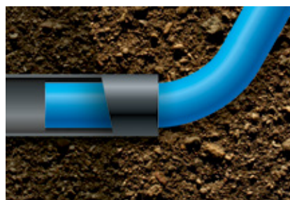
Протягивание новых труб через старые без разрушения последних
